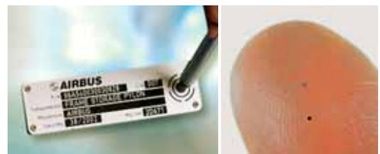
links: RFID-Tag (rund) und Lesegerät bei Airbus
